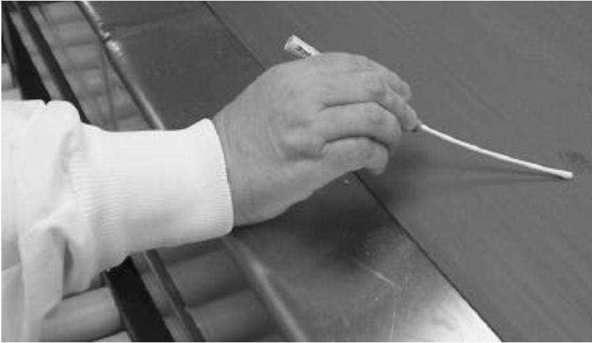
Gambar 4.1 Pengambilan sampel uji sanitasi pada sabuk conveyor dengan metode oles
