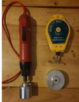
Gambar 1. (dari kiri ke kanan) Alat Penutup Botol Saat Ini, Alat Penutup Botol Diberikan, Simulasi Penggunaan Alat.
